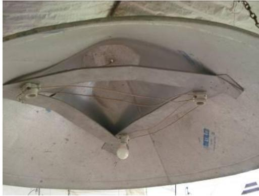
Fotografía 20. Vista inferior de una campana o “criadora” que utiliza bombillos en lugar de quemadores de gas.
