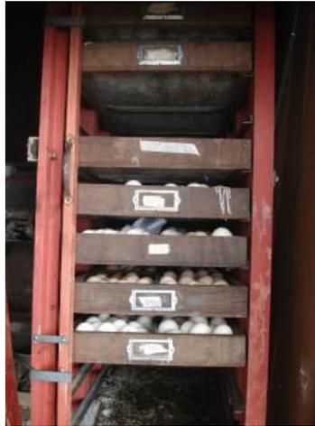
Fotografía 14. Incubadora y nacedora. Las bandejas son desmontables y cuentan con movimiento automático.
