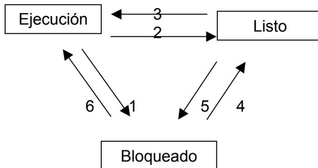
Es posible que se diera la situación apuntada arriba. Sin embargo, el diseño del sistema operativo sería más complicado, y se trata de simplificar. Imagine que tengamos simultáneamente las transiciones 3 y 6 (obviando la transición 4). Sería sumamente complicado para el sistema operativo determinar a cuál proceso le da prioridad, al que viene de desbloquearse o al que viene del estado Listo.
